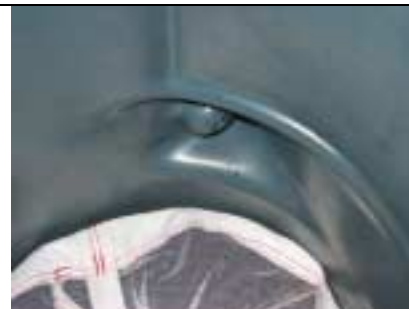
Fyll modulen till utloppsöppningen och sätt tillbaka skumdynan
