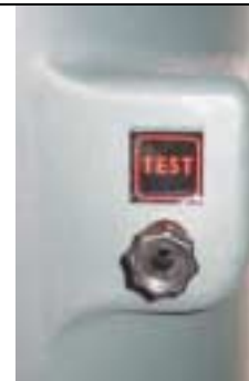
Kontrollera att testventilen är stängd, vrid åt höger för att stänga
