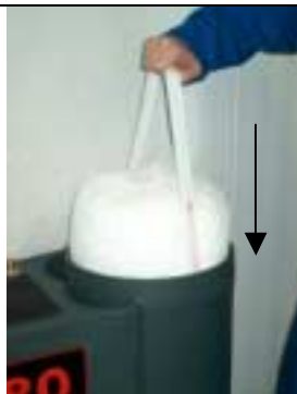
Sätt tillbaka poly-elementet och skjut det nedåt långsamt tills det vilar på botten av kärlet 1
