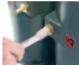
Alle Gewinde mit Ms Einsätzen und inkl. Schlauchtüllen
